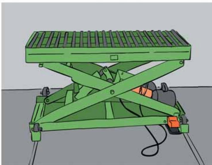
Los cilindros hidráulicos están acoplados a las tijeras para la elevación y descenso, pudiendo disponer de topes al objeto de conseguir un mejor ajuste de los finales de carrera superiores e inferiores.
