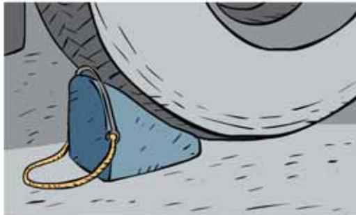
*Los vehículos deben permanecer inmovilizados con sistemas de retención manuales o automáticos en las operaciones de carga y descarga*
