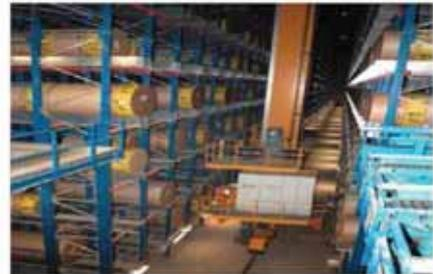
La configuración de los transelevadores permite que sean capaces de transportar y elevar cargas a gran altura y velocidad a través de pasillos estrechos. Un mismo movimiento se utiliza para la entrada y salida de materiales lo que consigue una eficiencia productiva.
