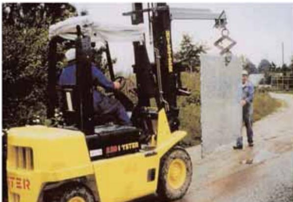
*En la elección de las carretillas deben tenerse en cuenta las condiciones meteorológicas para evitar protecciones improvisadas en los tejadillos de la carretilla*
