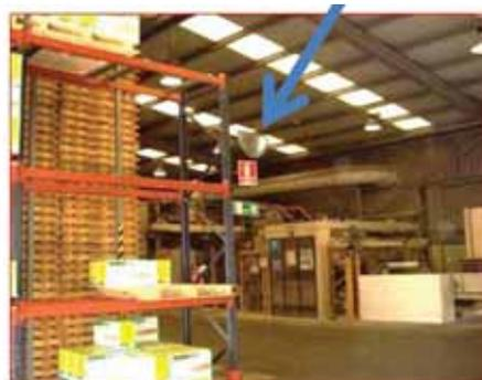
*Espejos en el acceso exterior y en el interior de una instalación de almacenamiento*
