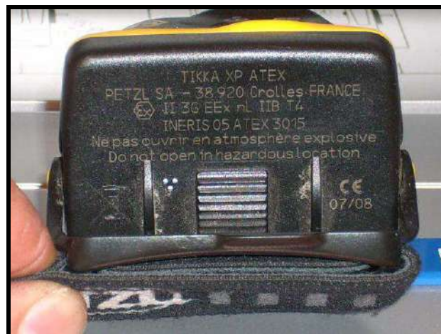
Ejemplo del marcado de un equipo ATEX
