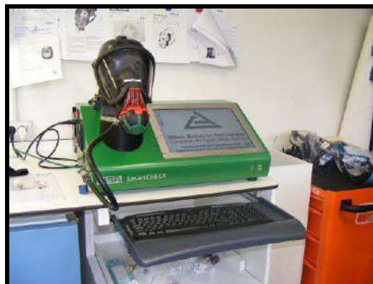
Revisión de funcionamiento y estanqueidad de la máscara de un ERA
